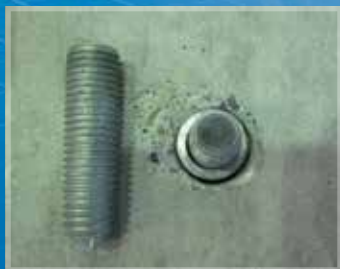
引張試験後の破壊状況
